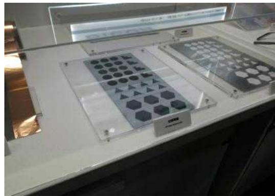
잉크젯으로 제작된 배터리(RICOH)
