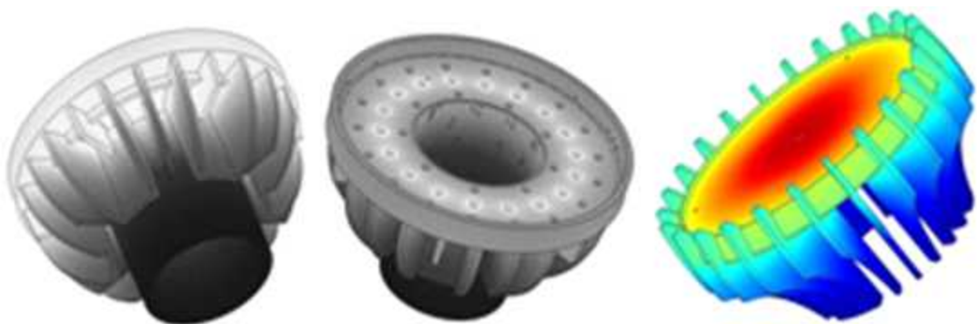
<그림 7. 40W급 LED 조명에 적용된 CNT 복합 방열 구조체>
