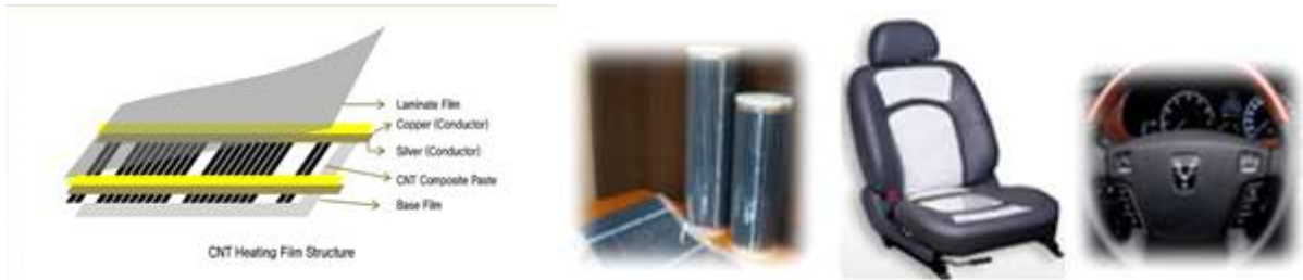
<그림 9. 다양한 형태의 CNT 발열체 (좌)바닥 난방 발열체, (b)발열체 적용 차량 부품>
