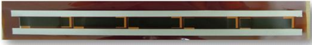
그림 49. 그림 48 발열체의 전압강하 문제를 해소한 패턴된 띠형 발열체의 사진
