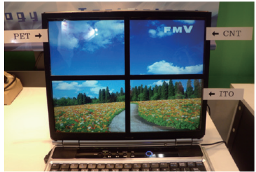
《 Toray사의 CNT 투명전극과 ITO 전극의 성능비교 》 (Toray에서 성능에 대해 밝히지 않았으나, ITO 전극과 비교하여 실제 디스플레이 구동시 큰 차이를 나타내지 않음)
